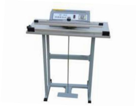
Machine de soudage a pédale, pour sacs en matière plastique thermo soudable, avec soudage par impulsion (de résistance à la chaleur pendant quelques secondes) et la minuterie pour le réglage.
